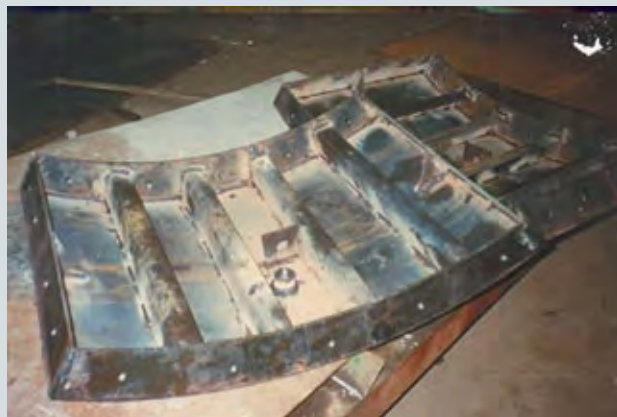
Рис. 6. Сегменты высокоточной стальной обделки диаметром 2,54 м
