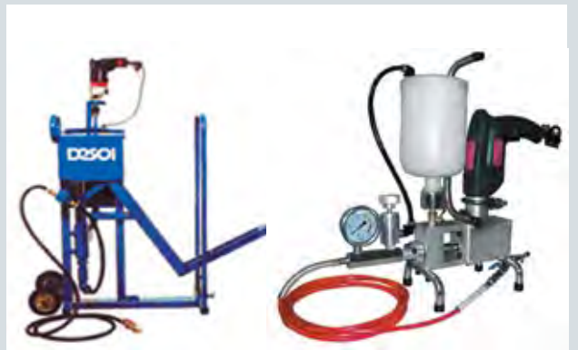
Рис. 7. Насосное оборудование для выполнения инъекционных работ
