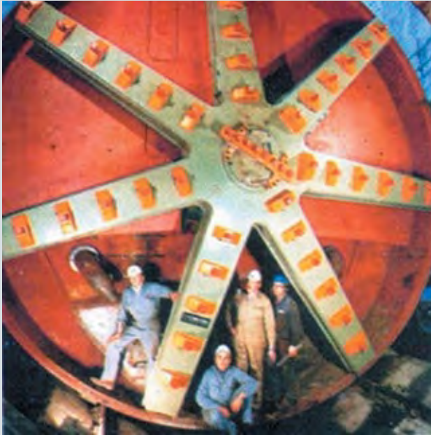
Рис. 4. Щит с суспензионным пригрузом фирмы «Херренкнехт»
