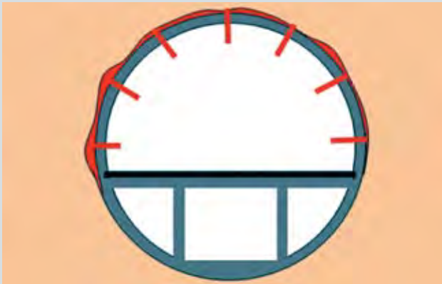
Рис. 3. Ликвидация течей через швы чугунных тюбингов в тоннеле метро
