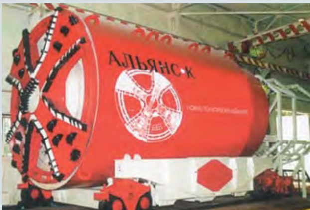
Рис. 8. Герметический щит «Топаз-4м» с грунтопригрузом
