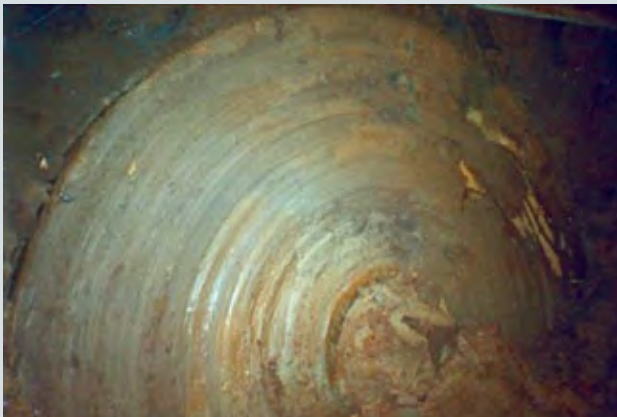
Рис. 5. Лобовая поверхность залипшего рабочего органа
